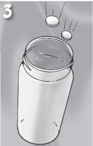
**3.** Deje caer dentro del tubo, dos tabletas para oxígeno disuelto (Dissolved Oxygen TestTabs®). Esto provocará que se derrame un poco de agua.
