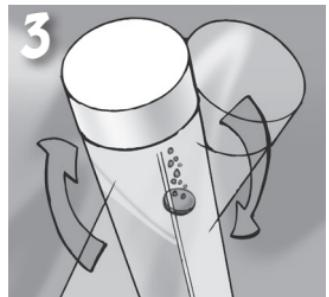
**3.** Selle y mezcle hasta que la tableta se haya desintegrado totalmente. Puede que queden pequeñas partículas en la muestra.
